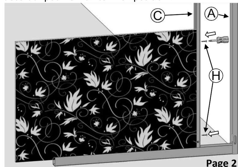
**Etape 13 :** Positionnez successivement les profils "D" et les panneaux décoratifs en les vissant, **sans forcer**, un par un :
