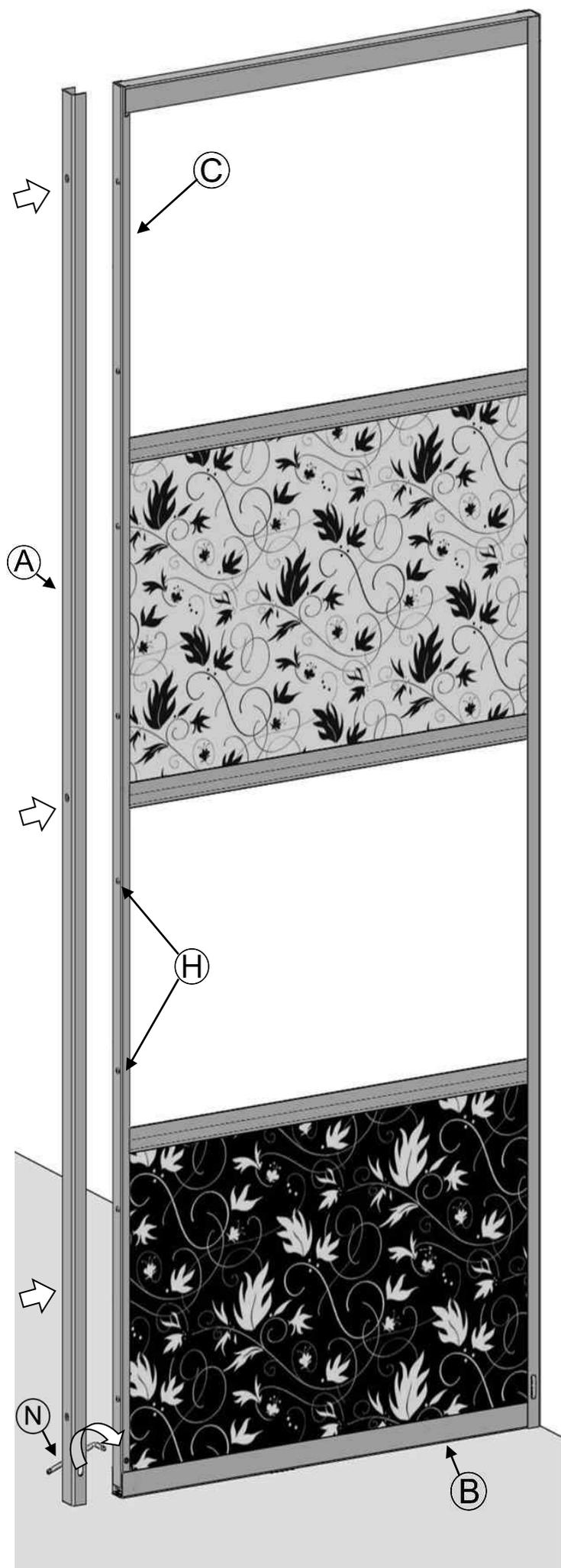
**Etape 18 :** Au travers du profil "A", percez le profil "C" avec un foret  $\varnothing 4.5$  mini à  $\varnothing 5$ mm maxi. Positionnez ensuite le rivet queue de sapin "J" dans le perçage pour maintenir le profil "A". Répétez l'opération pour les autres perçages restants.
