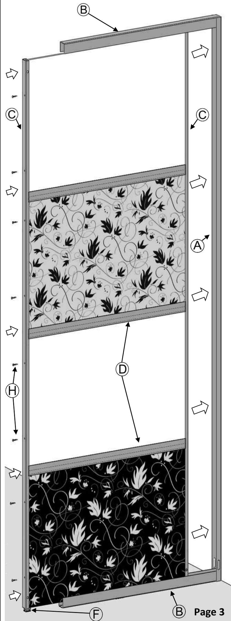
**Etape 17 :** A l'aide de la clé de serrage "N" vissez les vis de réglages des deux vérins compensateur "F" pour maintenir la cloison puis positionnez le second profil "A" sur le profil "C" :
