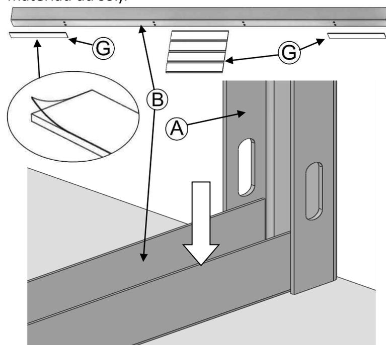
**Etape 6 :** Afin de déterminer sa position, réalisez un **PRE-MONTAGE** du second profil "A" à l'autre extrémité du profil "B" :
