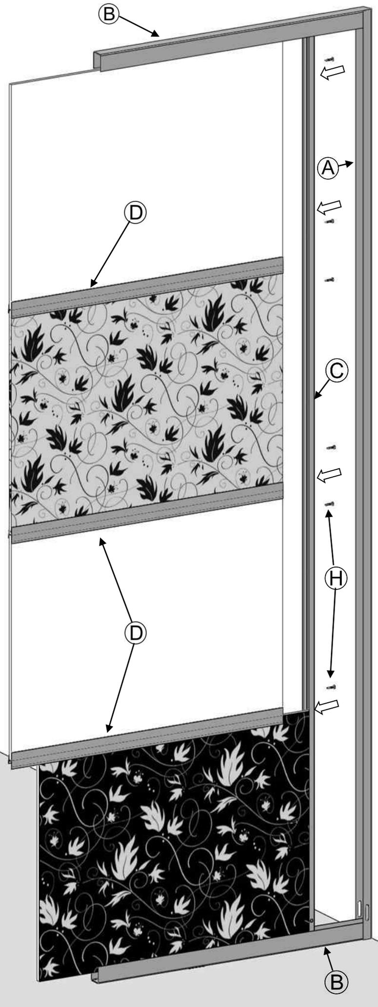
**Etape 14 :** Collez deux morceaux d'adhésif "M" double face d'épaisseur 3.2mm sur le profil "C" et retirez la pellicule blanche des adhésifs "M" :
