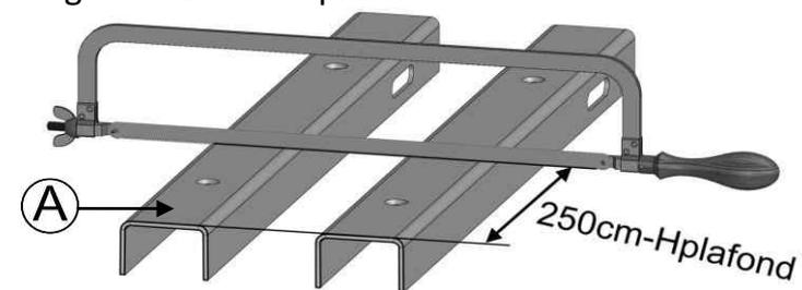
**Etape 2 :** Si "Hplafond" est égale à 250cm, passez à l'étape 4, Si "Hplafond" est inférieure à 250cm, recoupez les deux profils "C" de la longueur "250cm-Hplafond". **Attention, Conservez la symétrie entre les deux profils "C" :**
