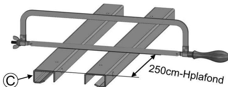
**Etape 3 :** Si "Hplafond" est égale à 250cm, passez à l'étape 4, Si "Hplafond" est inférieure à 250cm, recoupez une bande d'une largeur de "250cm-Hplafond" sur l'un de vos panneaux décoratifs de remplissage de la gamme "Do It yourself" :
