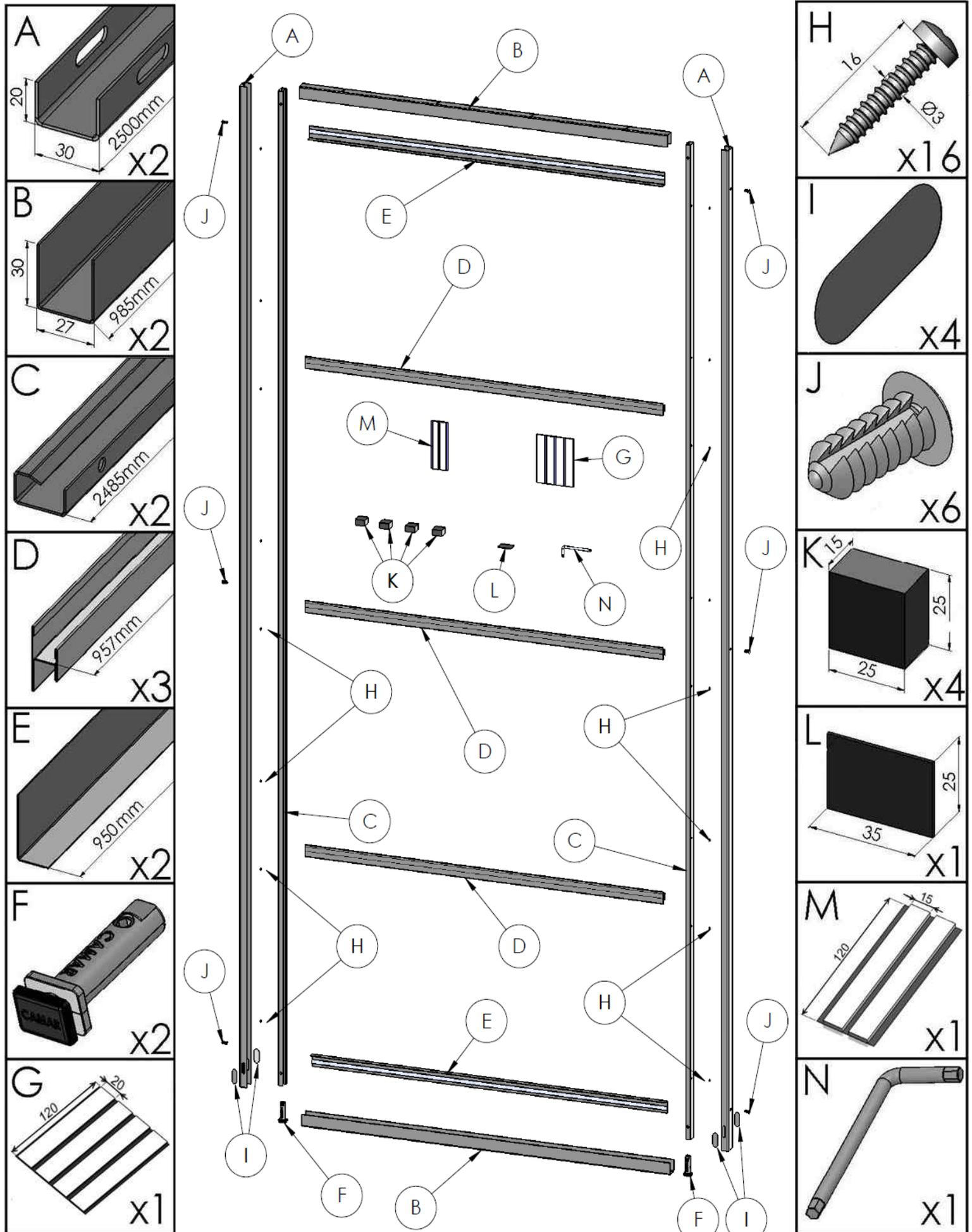
**Etape 1 :** Mesurez la hauteur "Hplafond" entre votre sol et votre plafond : Si "Hplafond" est égale à 250cm, passez à l'étape 4. Si "Hplafond" est inférieure à 250cm, recoupez la partie **opposée aux deux perçages latéraux** des deux profils "A" de la longueur "250cm-Hplafond" :
